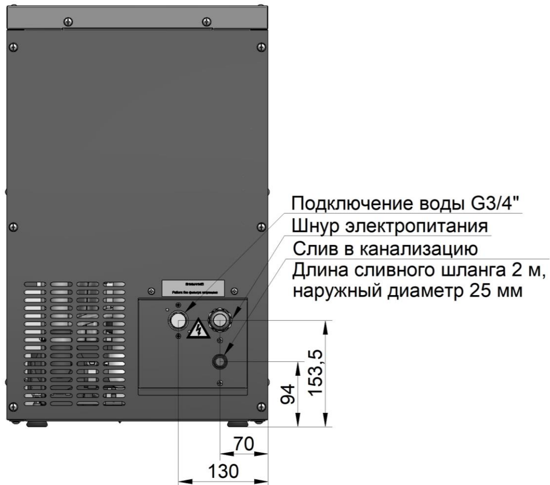
Рис. 5 Схема подключения льдогенератора
