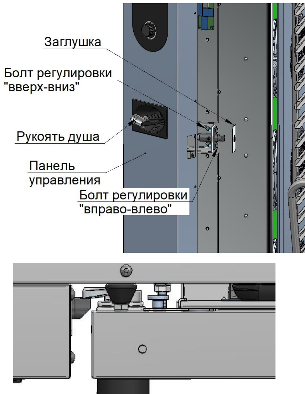
Рис.22 Регулировка замкового устройства
