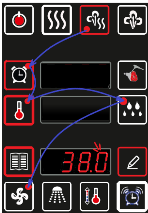
Рисунок 5 Задание шага программы на примере режима «Конвекция+Пар» с параметром «Таймер»
