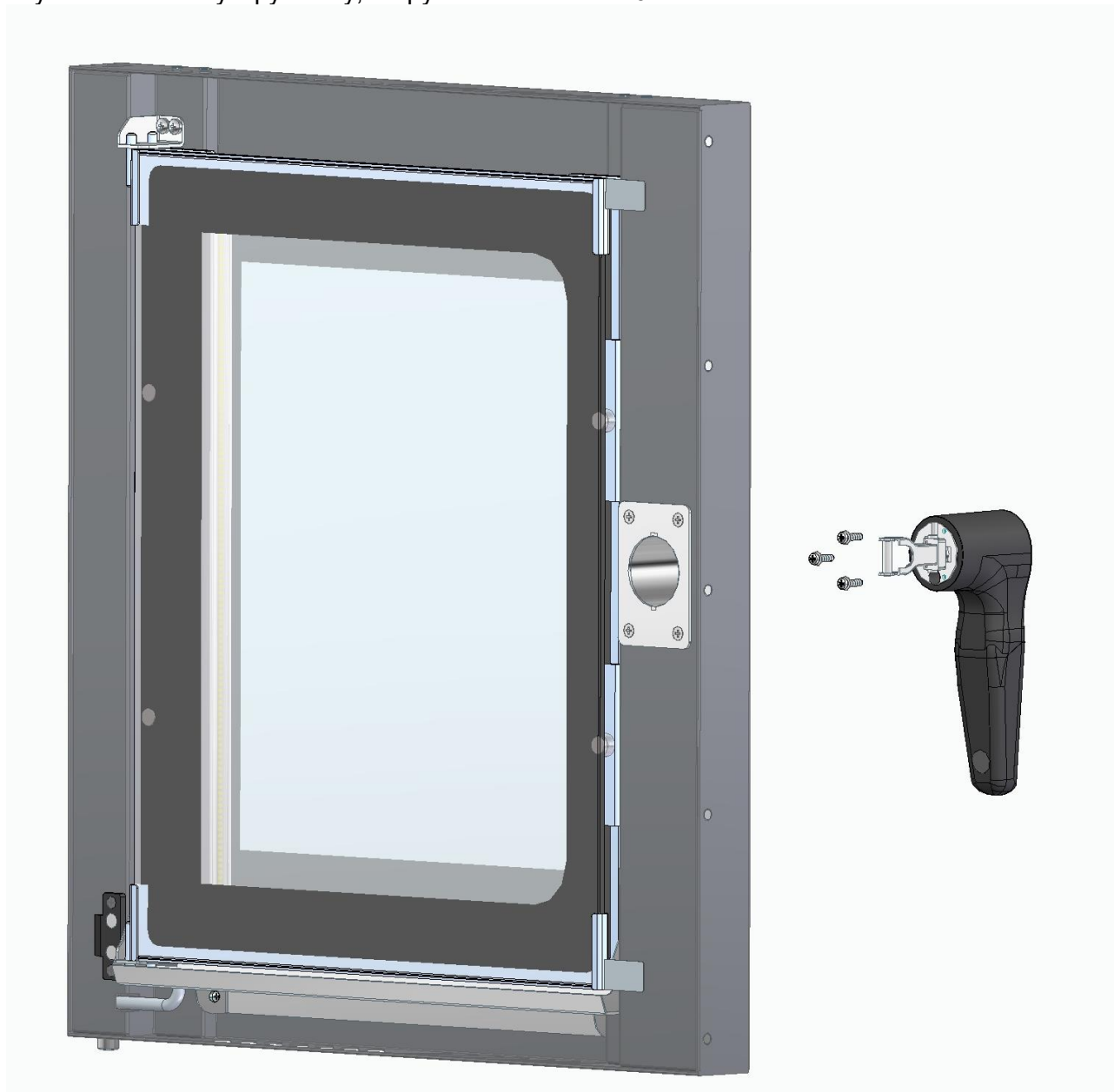
Рис.21 Ремонт замкового устройства
