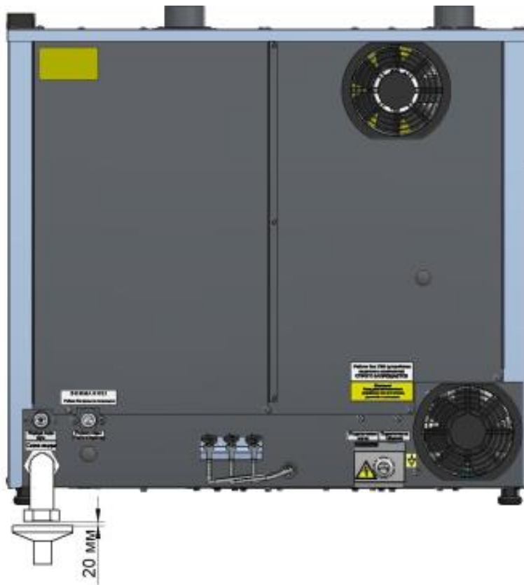
Рис.5. Подключение к системе канализации
