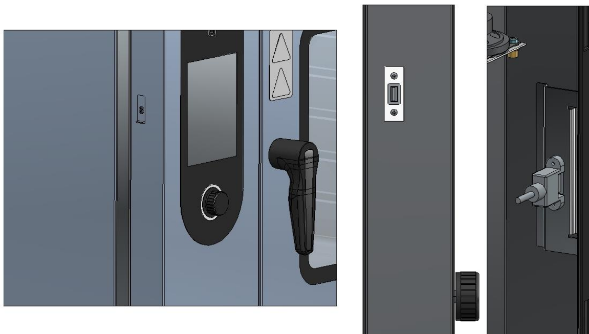
Рис. 2 Общий вид USB/COM-портов на панели управления
